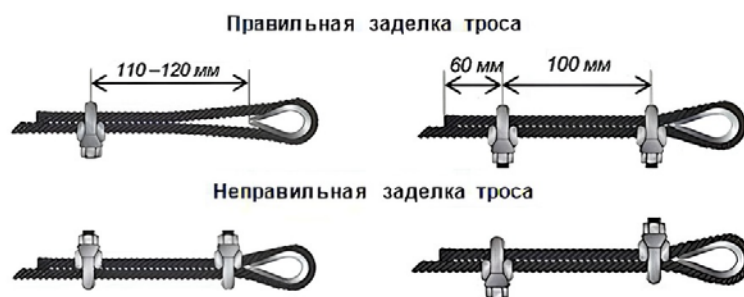
Рисунок 6 – Заделка троса
